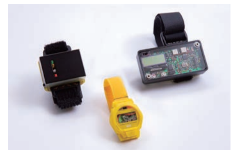
人体を信号伝送路とするウェアラブル通信機器
