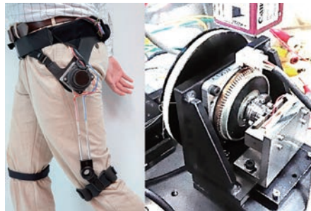
歩行アシストシステムと新原理アクチュエータ
